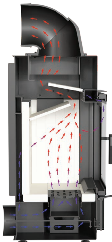
Rysunek 8. Schemat obiegu powietrza wewnątrz wkładów z serii LUCY.
